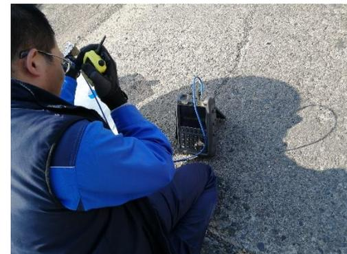
時間、空間的に大きな変動があったため、ホーンアンテナの位置をずらしながらピークホールドで電力を測定した。
