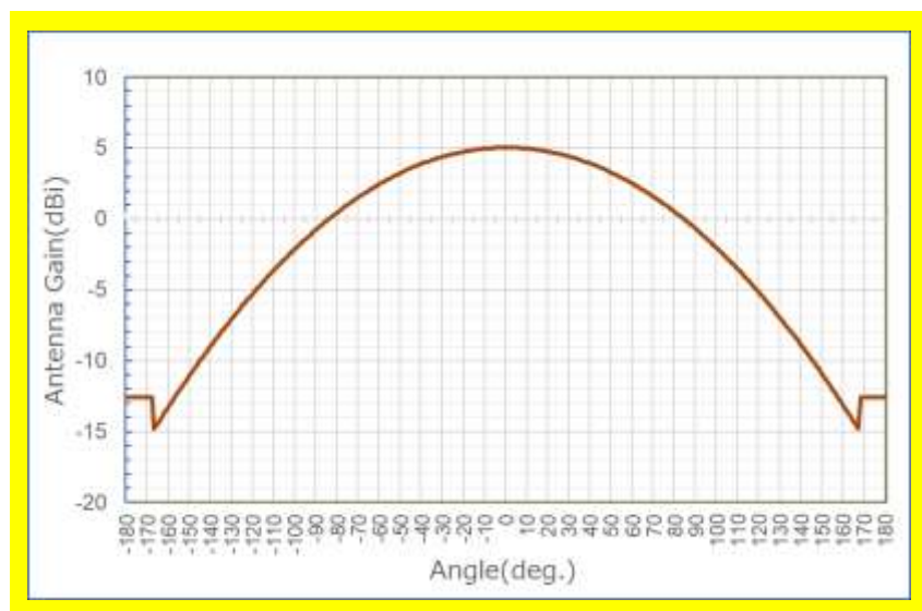
図3-1 パルス変調方式のセンサーシステムのアンテナパターン (Beam=130deg.、Gain=5dBi、Sidelobe=-12.6dBi)
