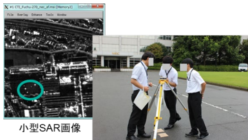
地上検証時の様子(1例) (GPSによるコーナーリフレクタの位置測量) 中央及び右の2名が学生 (左はNEC職員)
