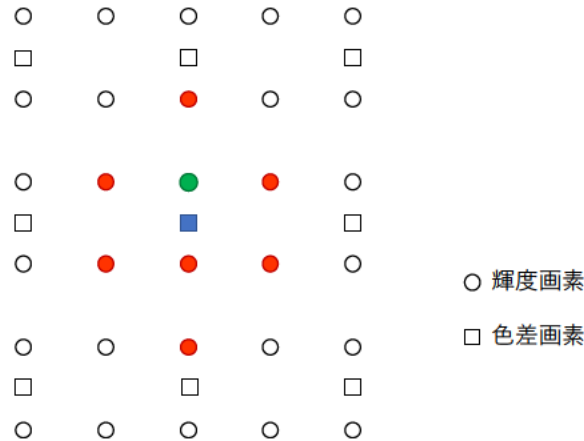
図 7-9 CC-ALF のフィルタ処理に用いる画素位置
