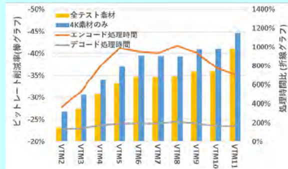
図1: VTMの圧縮効率、処理時間比
