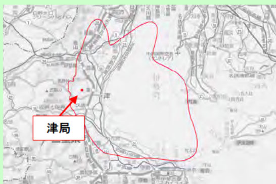
実験エリアの目安(電界強度60dB \mu V/m)
