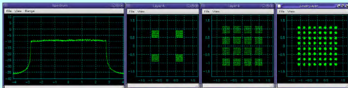
図2 LDM方式の処理例
