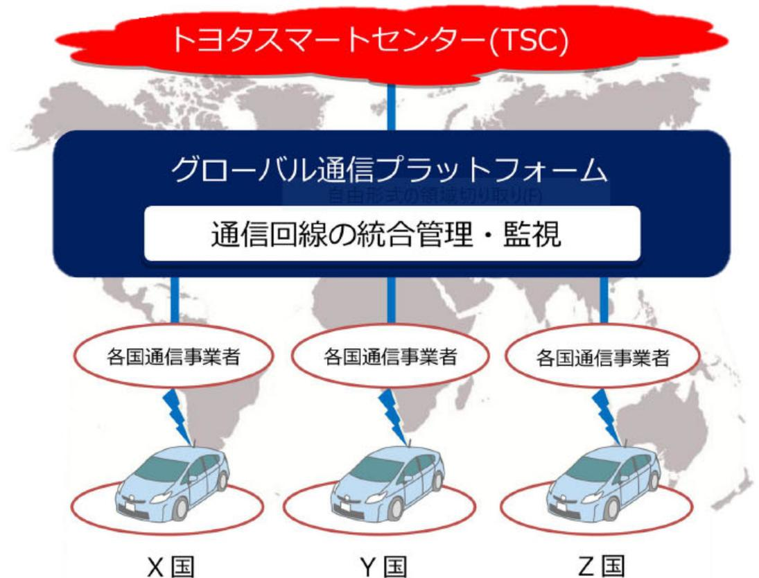
2016年プレスリリースから：「グローバル共通DCMを搭載した車両の位置情報から、国・地域ごとに選定した通信事業者への自動的な接続・切替と、通信状態の監視を統合的に行うもので、これにより、コネクティッドカーに必要な、高品質かつ安定した通信をグローバルで維持することができる。」
