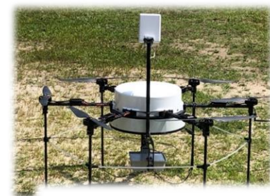
有線ドローン中継基地局
