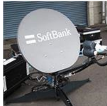
可搬型衛星アンテナ
