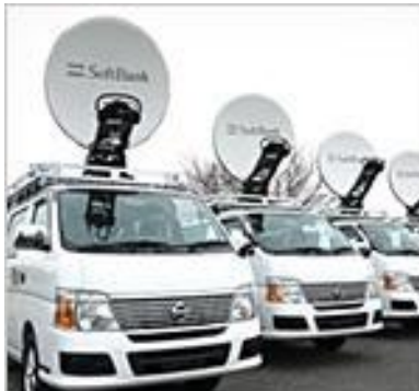
可搬型移動基地局
