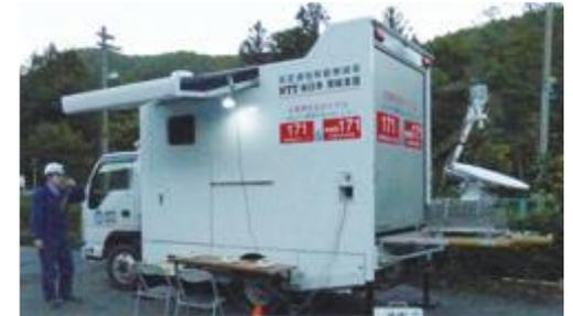
衛星通信移動無線車による通信確保
