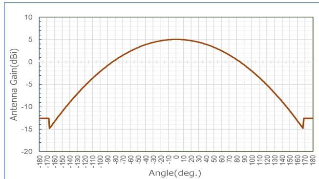
パルス変調方式のセンサーシステムのアンテナパター
