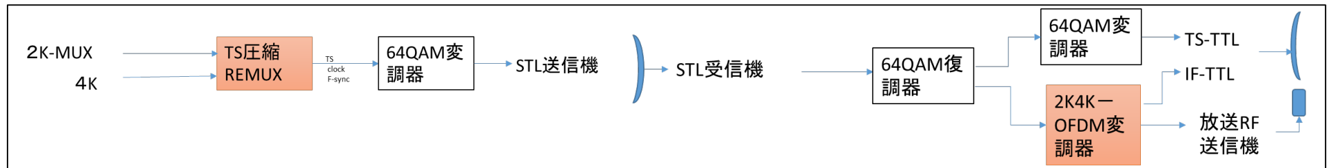
現行STL/TTL送受信装置を用いる技術手法例(SISO方式)
