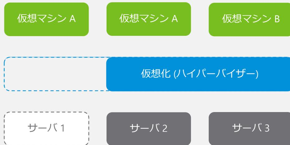
HW 故障(機器故障)時には、別の HW で仮想マシンが自動で起動し直す
