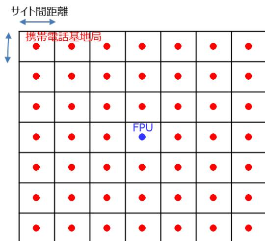
図 3.3-1 合成干渉量計算のイメージ図
