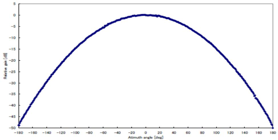
図 3. 2-1 LTE-Advanced 基地局の送受信アンテナパターン(水平面)
