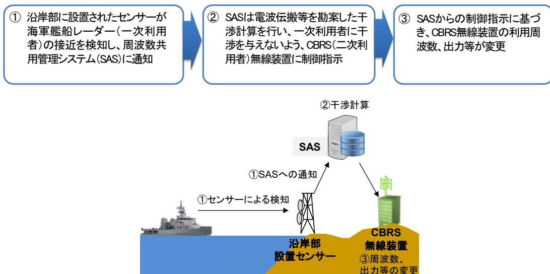
図 1. 3-1 米国の SAS (Spectrum Access System) イメージ
