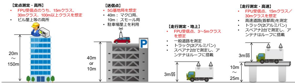
送信点については、電波伝搬特性検証のための安定したデータ取得のために CW 波（無変調波：2.1GHz 帯／EIRP：5W、アンテナ：オムニ）を利用し、地点については都心・郊外における高所・低所の 4 か所を設定した。受信点については十分な測定サンプル数を計上するため走行測定：高速道路測定及び地上測定（送信点から一定範囲の主要道路、高速道路と並行した道路）を行った。
