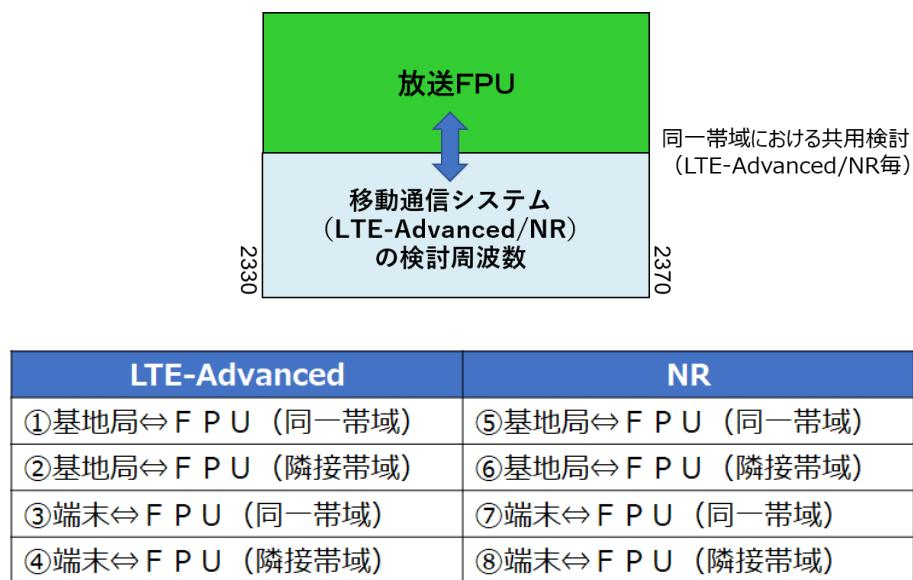
図 3. 3-2 移動通信システムと放送 FPU の干渉検討パターン
