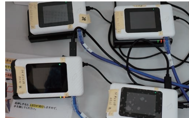
教室内にローカル5Gと通信できるモバイルルーターを設置。
