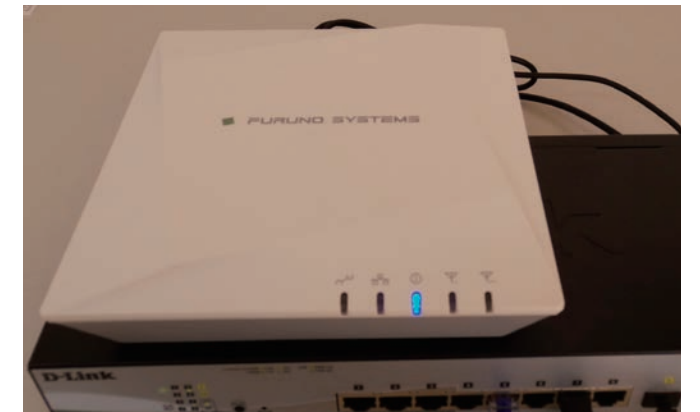
モバイルルーターと有線で接続された無線アクセスポイント。本実証で使う端末はこのアクセスポイント経由で通信を行う。
