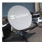
可搬型衛星アンテナ
