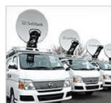
可搬型移動基地局
