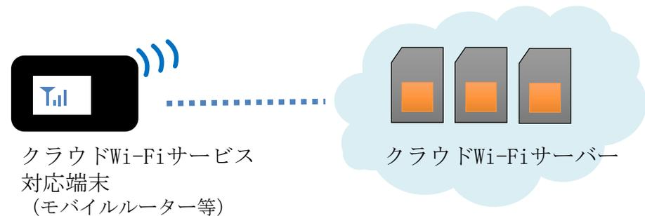
SIMカードの差込を要さない専用のWi-Fiルーターを利用し、サーバ上の大量のSIMカードの中から自動的に最適なものを選択して接続のうえデータ通信を行う「クラウドSIM」と呼ばれる技術を活用した通信サービス。
