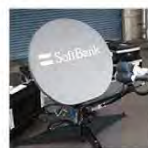
可搬型衛星アンテナ
