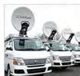
可搬型移動基地局
