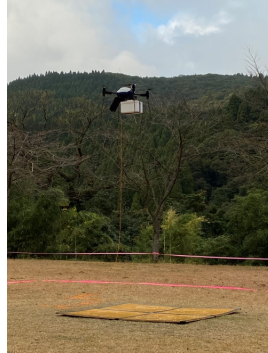
上空のUAVでWiFi6を受信しLTEへ中継
