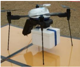
使用したUAV（有線給電ドローン）と実験設備(Wi-Fi6 中継装置及びLTEスマホ)収納形態
