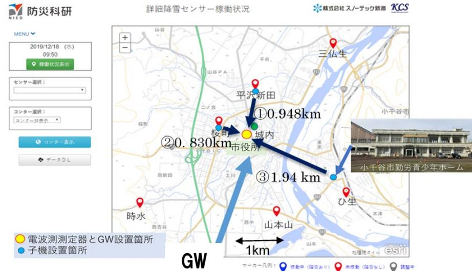
電波伝搬試験用装置の設置位置と主な電波の経路（地理院地図を加工して作成）
