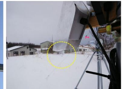
2020年1月25日から26日にかけての吹雪によるLoRaのGWへの着雪（左）と2020年1月31日の降雪後の融雪による積雪深センサでのつららの生成（右）
