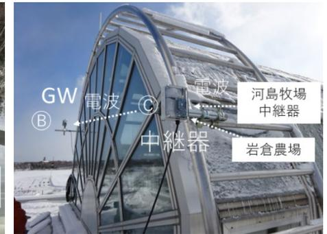
電波伝搬への直接の影響は確認できなかったが、左下のように、新庄雪氷環境実験所で実施した着雪実験の形状通りの着雪が、2020年1月25日から26日にかけての吹雪により生成した。26日に気温が上昇して落雪したため、この上に冠雪して融雪が生じ、電波伝搬に影響をもたらすまでには至らなかった。
