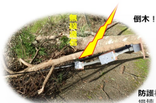
防護柵損壊を通知
