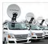
可搬型移動基地局
