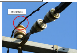
断線した電線ケーブルの写真
