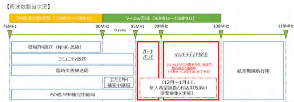
V-Low 帯域において、既存の FM 放送技術によるシステムを導入する場合は、超短波放送用周波数と移動受信用地上基幹放送の干渉回避のため設定しているガードバンド（95MHz～99MHz）が不要となり、同周波数帯も含めて利用が可能となる。また、108MHz 以上の隣接する周波数を利用する航空無線航行用との干渉回避のため移動受信用地上基幹放送の周波数を下方向にずらして利用（オフセット）する対策も不要となる。したがって、詳細な干渉検討は必要であるが、既存の FM 放送技術を活用する場合は 95MHz～108MHz まで全帯域の有効利用が可能となる。
