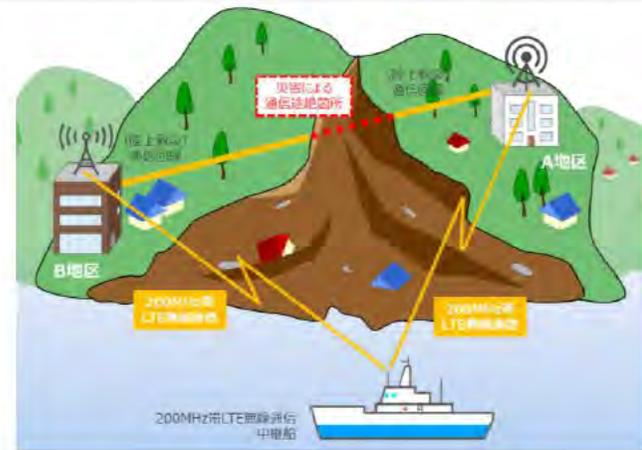
例えばA地区とB地区の間で土砂崩れ等が発生し、陸上通信回線が損傷し通信が途絶した場合でも、海上の船舶が中継することで、A地区 ⇄ 船舶 ⇄ B地区 経路で通信可能となる
