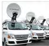
可搬型移動基地局
