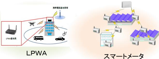
現在のアクティブ系システムは位置、温度、水位、メーターの表示値、機器の異常信号等の少量データの情報を比較的**低周波で通信**するサービスで使われている。
