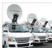
可搬型移動基地局
