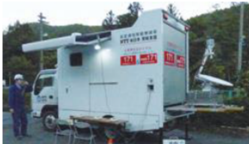
衛星通信移動無線車による通信確保
