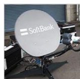
可搬型衛星アンテナ
