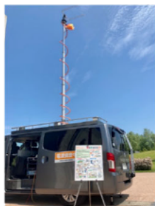
伸縮ポール装備の車両に臨時災害放送局の送信アンテナを設置
