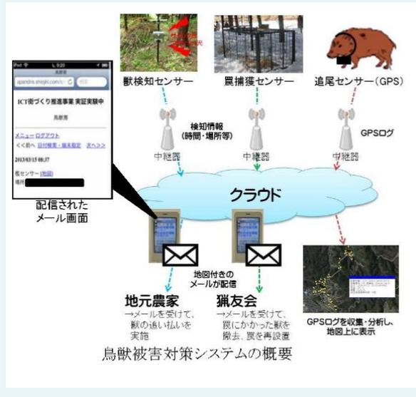
○市内に設置した様々なセンサーから収集した情報を効率的・効果的に住民等に配信する仕組みを構築。
