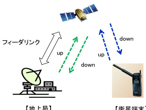
図 5-1-2 Globalstar システムの概要
