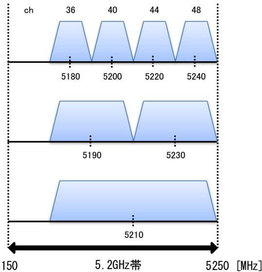
図 6-1-1 5.2GHz 帯自動車内無線 LAN システムの周波数チャネル配置図
