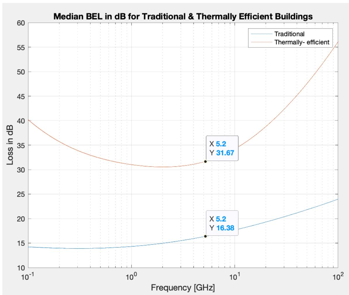
図 5-3-1 ITU-R 勧告 P.2109 による建物遮蔽損失
