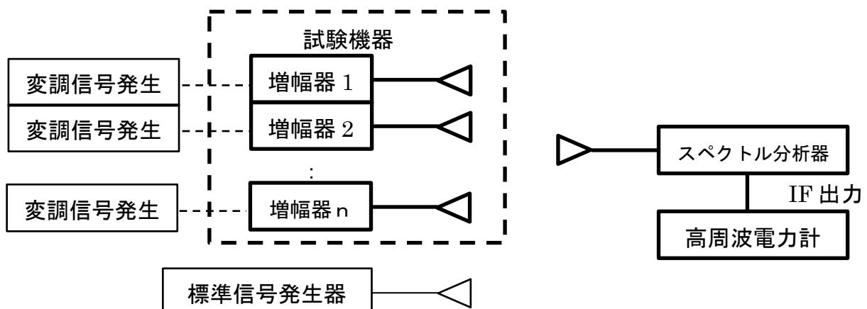
図 6-2-3 空中線電力測定系統図（空中線端子なしの場合）
