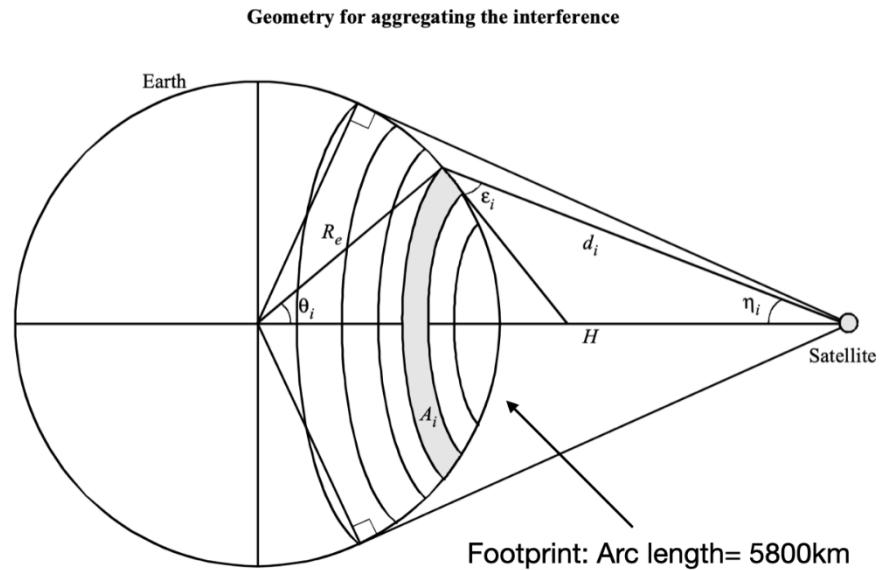
図 5-3-3 移動衛星局と地球の位置関係 (ITU-R 勧告 M. 1454 より転載)
