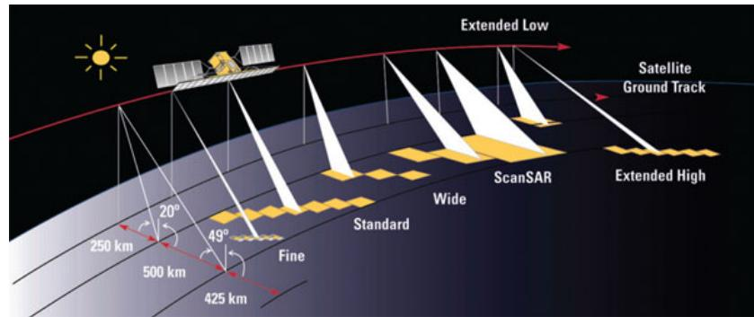
図 5-1-4 地球探査衛星システムのイメージ<sup>[14]</sup>
