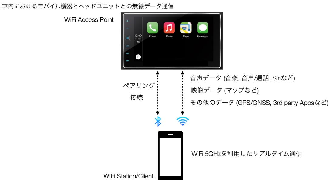
図4-1-2 Projection Typeによる広帯域チャネルを用いた高速・大容量通信
