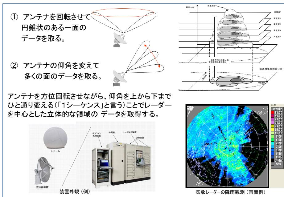
図 5-1-3 気象レーダーの概要<sup>[13]</sup>
