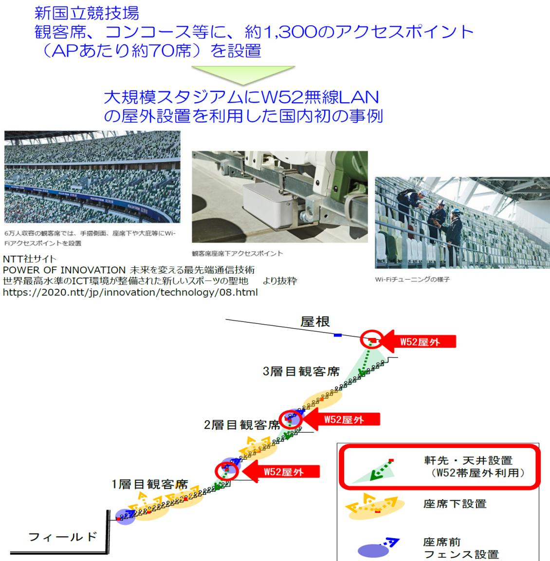
図 2-2-1 新国立競技場における 5.2GHz 帯高出力データ通信システムの設置状況
