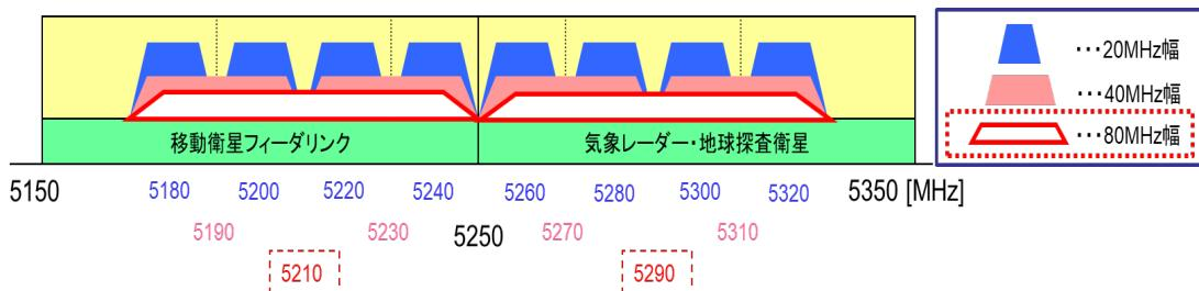
図 2-5-1 5.2GHz 帯及び 5.3GHz 帯無線 LAN のチャネル配置
