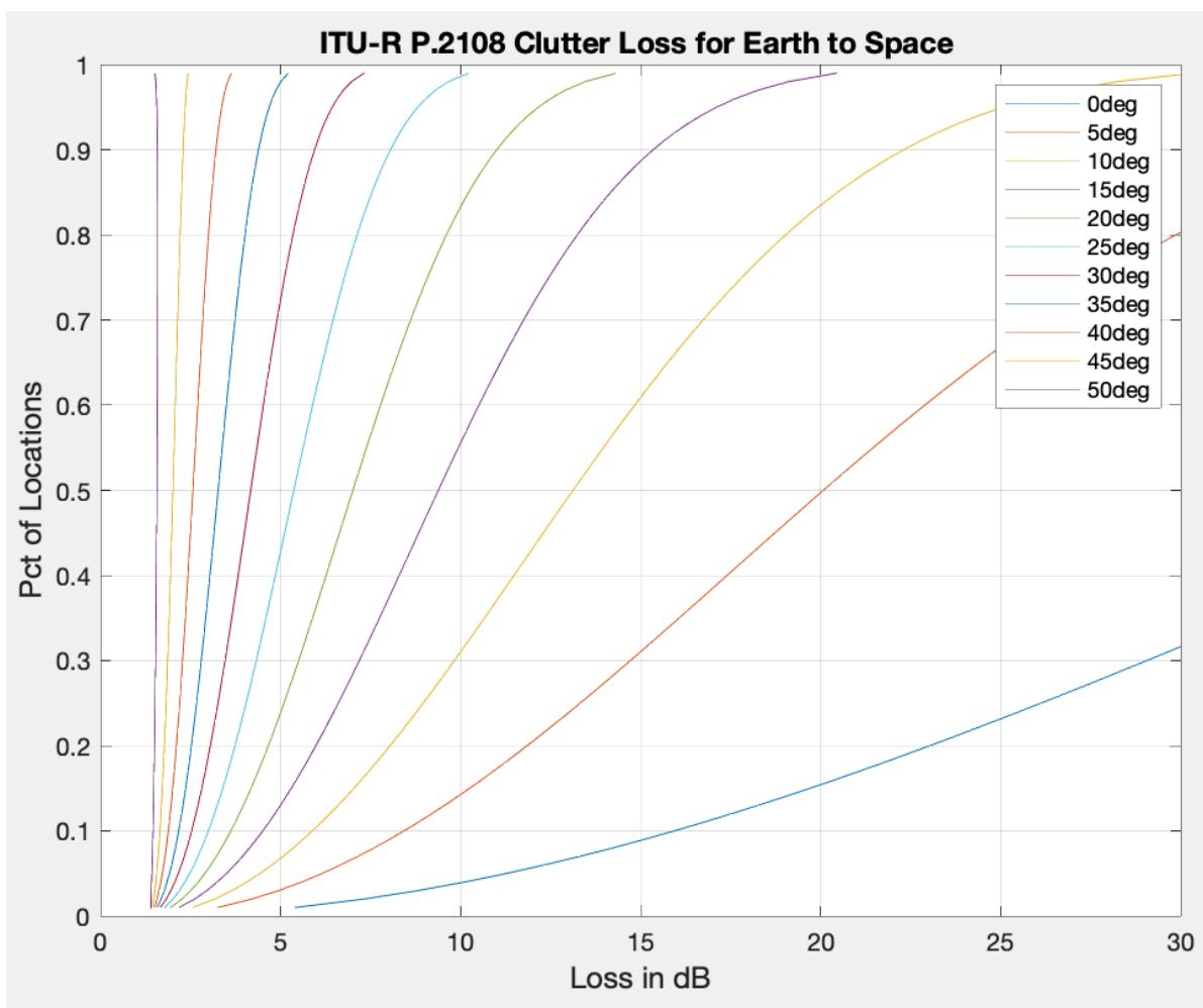
図 5-3-2 ITU-R 勧告 P.2108 によるクラッタ損失
