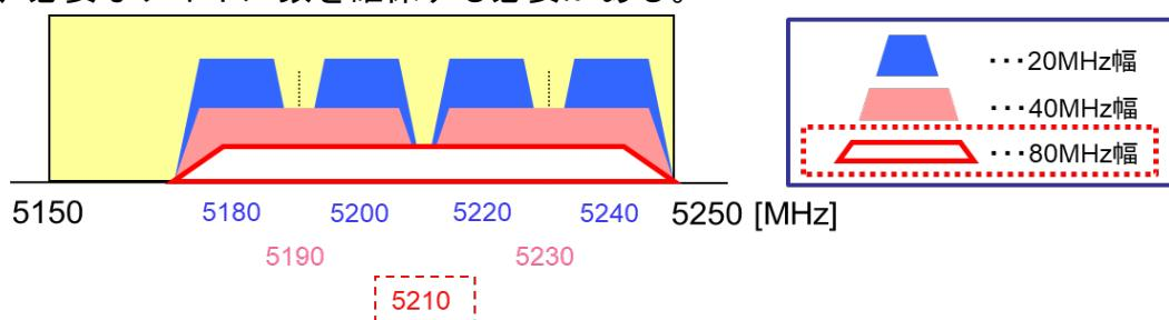
図4-1-1 5.2GHz帯無線LANシステムのチャンネル配置
