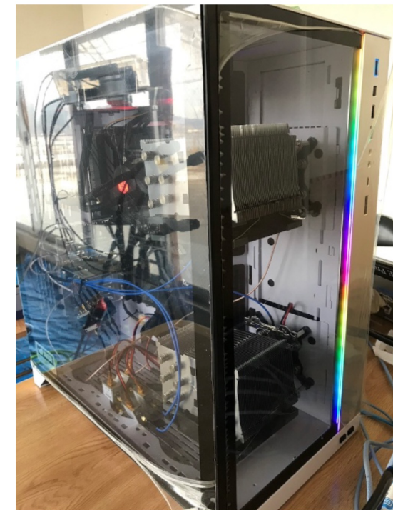
[画像のクリックで拡大表示] 提供するソフトウェア基地局「FW-L5G-1」。一般的なサーバーで動作する (出所：NECネットエスアイ)
