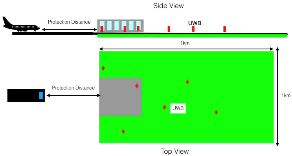
図5-23 航空機搭載気象レーダーでのアグリゲートシミュレーションモデル
