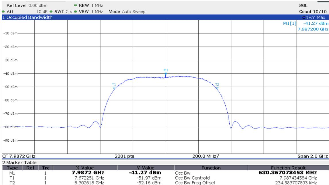
図 3-2 UWB 無線システムの送信波形 (X1D)
