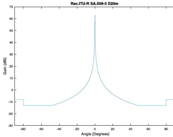
図 3-18 勧告 ITU-R SA.509-3 のアンテナ特性
