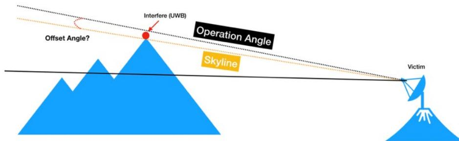
図5-33 宇宙研究業務地球局のシングルエントリー シミュレーションモデル
