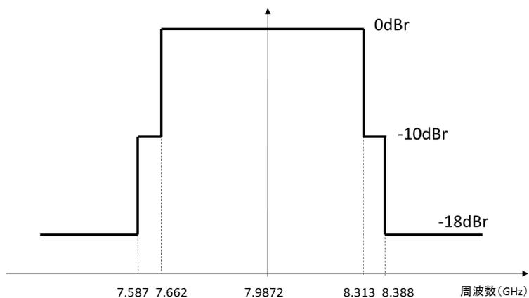
図1-3 IEEE802.15.4a (チャンネル9) のPSDマスク
