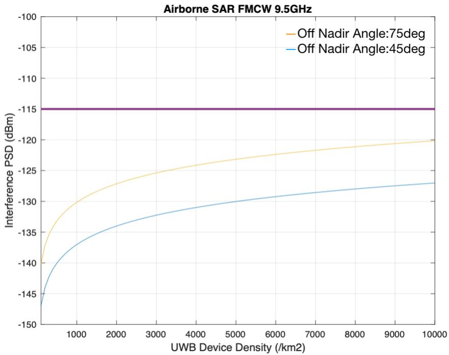
図5-32 FM-CW方式の諸元を用いた計算結果
