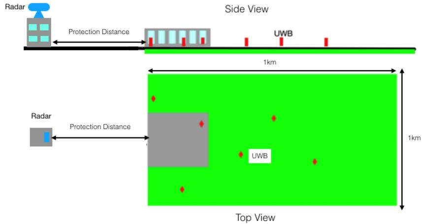
図5-29 固定型気象レーダーのアグリゲートシミュレーションモデル
