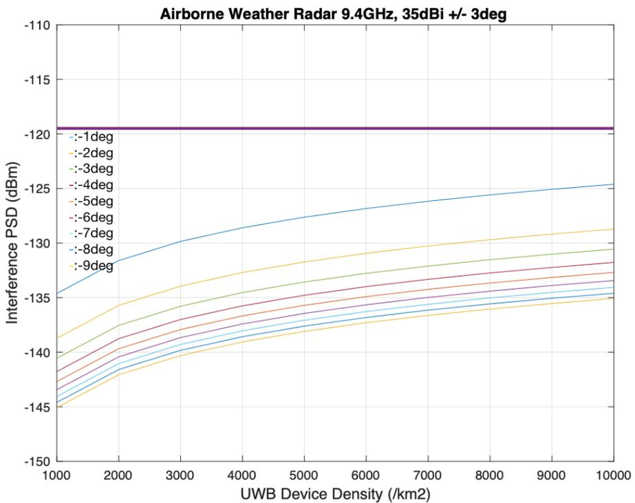
図5-18 高度520m条件での計算結果（アンテナ諸元2）
