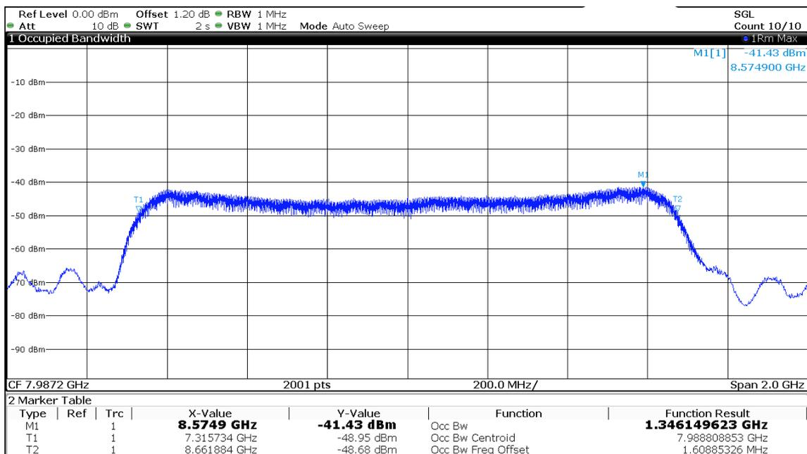
図 3-3 UWB 無線システムの送信波形 (X1D)
