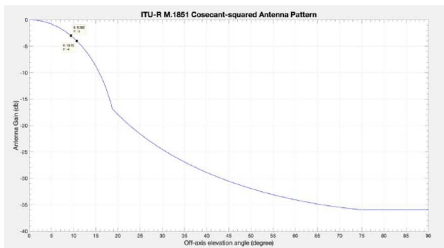
図 3-7 海上レーダーのアンテナパターン
