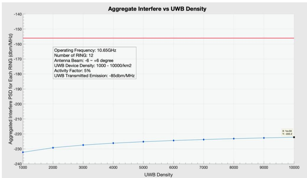
図5-41 10.65GHzでの計算結果
