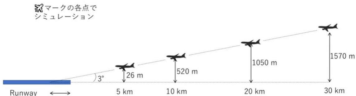
図5-12 シミュレーションで用いた条件
