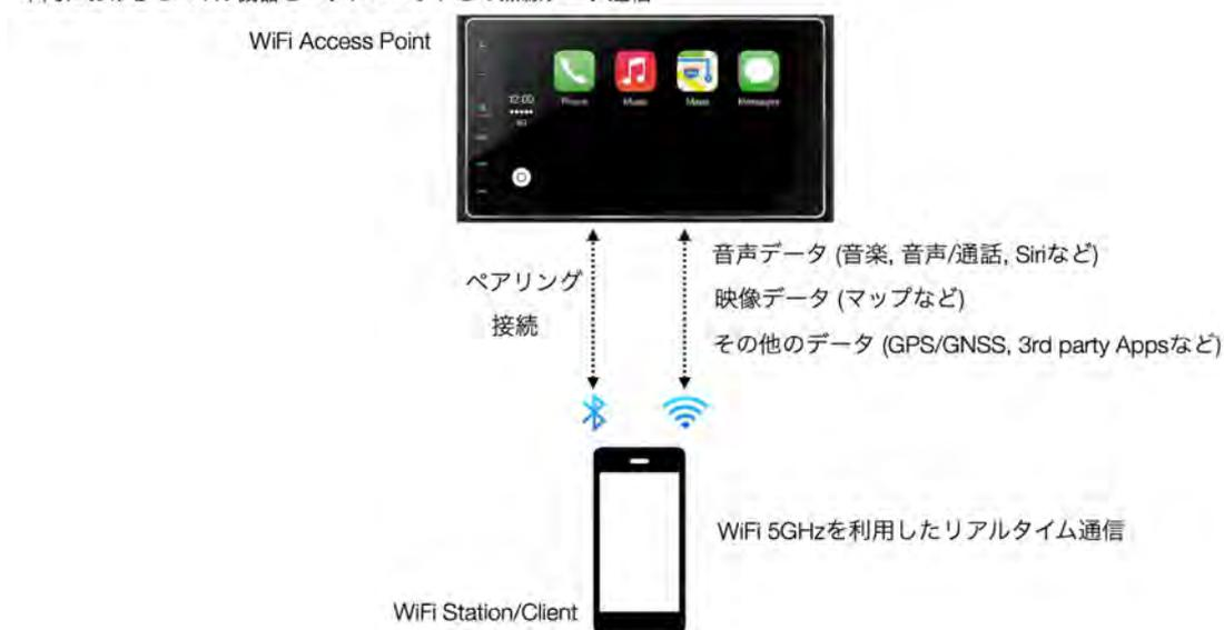
また、図 4-1-2 に示すとおり、後部座席では、同時にタブレット端末等で車載器の TCU を経由して 4K 映像などのストリーミングサービスの利用が想定される。このため、自動車内では、少なくとも無線 LAN チャンネル数は 2 以上が望まれる。なお、4K ストリーミングでは、一般的なアプリケーションにおいて、必要なスループットとして、20Mbps 程度<sup>[1]</sup>を考慮すると IEEE802.11n や 802.11ax 規格での対応が対応可能であると考えている。
