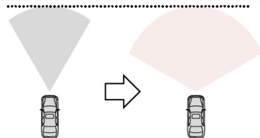
空中線利得が低い広角ビームを有するレーダーでは、現行法令より大きな電力の給電により、検知距離の低下分を補うことで、射程を維持しつつ物体検知範囲の広角化を実現するなど、自由度の高い設計が可能となる。
