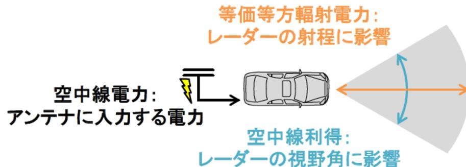
現行法令下で空中線電力10dBm、空中線利得40dBiのレーダーの空中線ビームを広角化(利得を40dBiから20dBiに下げる)する場合の射程の例(青■):
