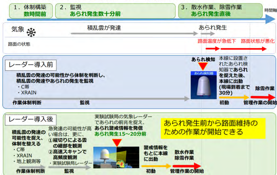
図1.2.3-1 X帯気象レーダーの実証実験結果（高速道路）
