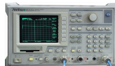
測定用受信機 (スペクトラムアナライザの使用)
