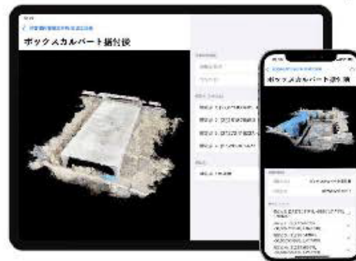
ボックスカルバート計測データ
