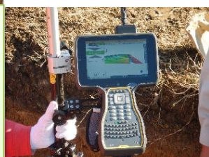
3D設計データ +追尾型TSで 座標・高さ(XYZ座標)の 確認が瞬時に可能！
