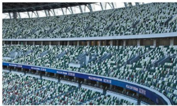
6万人収容の観客席では、手摺側面、座席下や大庇等にWi-Fiアクセスポイントを設置
