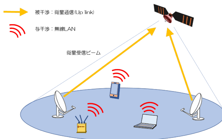
図 6.3-40 無線 LAN から静止衛星システム(Uplink)への与干渉
