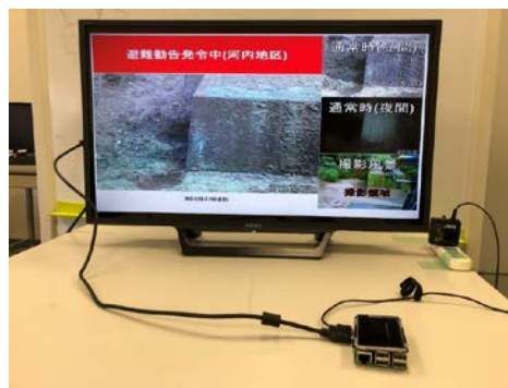
図 4 開発したテレビ画面への災害情報表示システム
