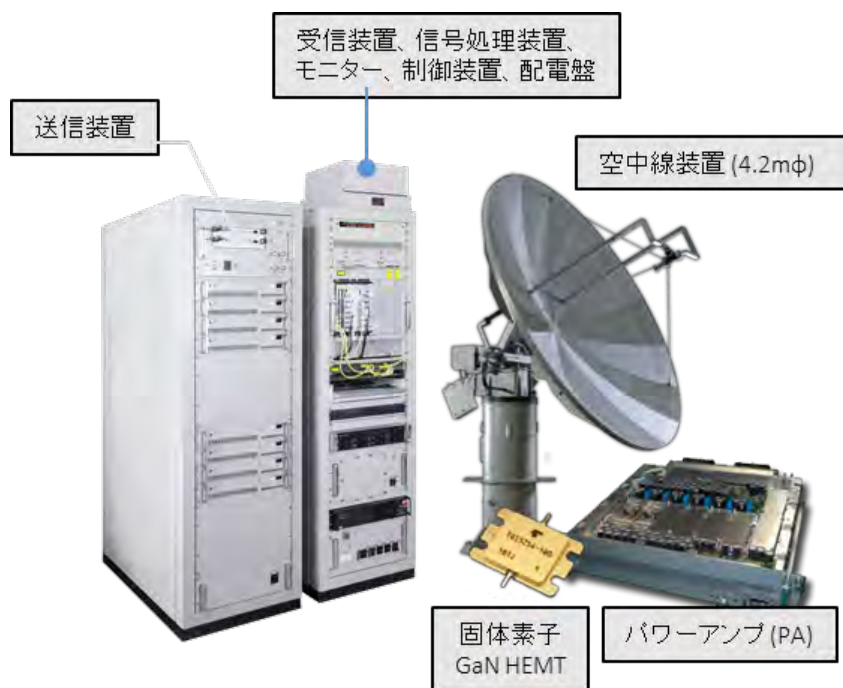
図 1.3.3-4 固体化MPレーダーシステムの外観
