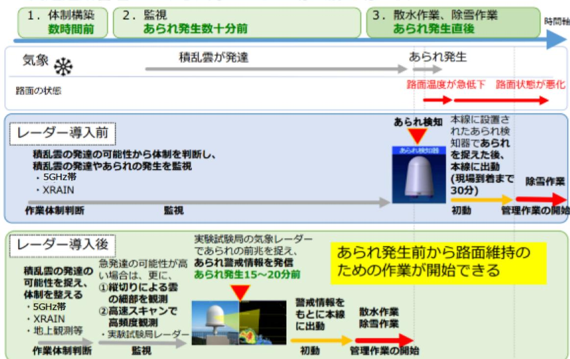
図1.2.3-1 9GHz帯気象レーダーの実証実験結果（高速道路）
