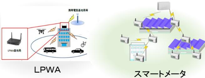
現在のアクティブ系システムは位置、温度、水位、メータの表示値、機器の異常信号等の少量データの情報を比較的**低周波**で通信するサービスで使われている。
