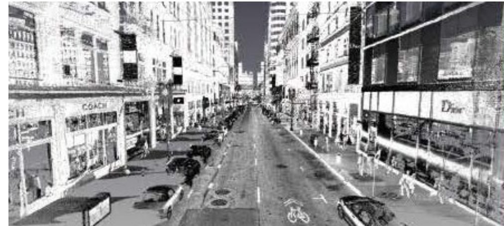
図: (上) MMSの構成例 (下) MMSで得られた3次元データの例 [8]
