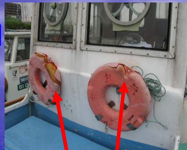
救命浮環に亀裂
