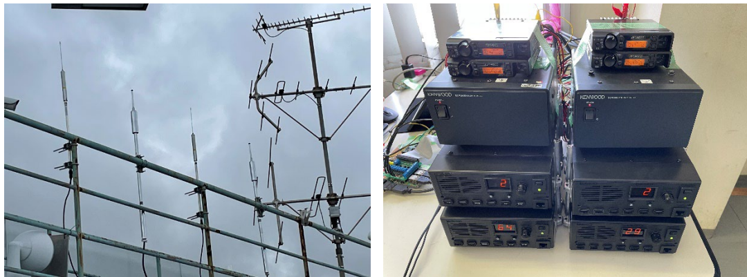
図 資料 6-3 利用率測定の様子(左がアンテナ、右が受信機)
