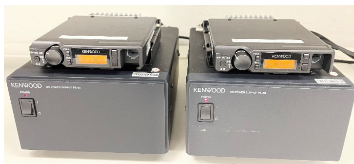
図 資料 9-4 車載型無線機と定電圧電源装置
