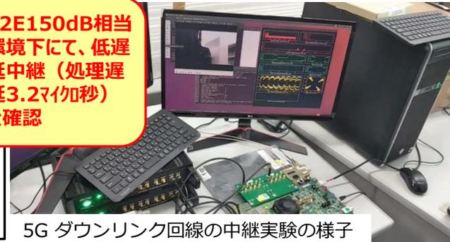
① タフ無線環境におけるカメラ画像からの電波伝搬予測の実証 (左) 及び低遅延非再生中継の実証 (右)
