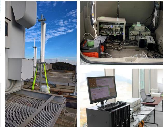
③ STABLE実験におけるDL送信ダイバーシチアンテナ(左)、車載移動局(右上)、屋内移動局(右下)
