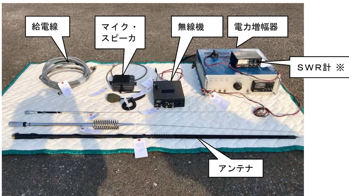
※SWR計：給電線の定在波比を測定する機器（送信された電波がアンテナから効率よく放射されているかを測定する機器）
