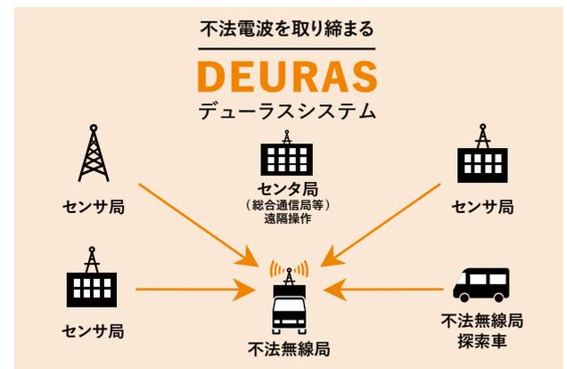
不法な電波などを取り締まるため総務省が電波監視システム「DEURAS（デューラス）」を整備・活用しています。全国に設置されたセンサ局や不法無線局探索車で、不法電波の発射源を探し出します。
