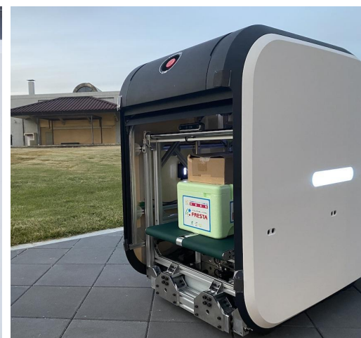
機体とIoT宅配ボックス間の自動積載システム
