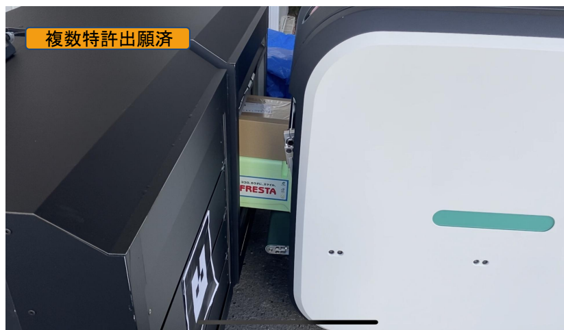
機体とIoT宅配ボックス間の自動積載システム
